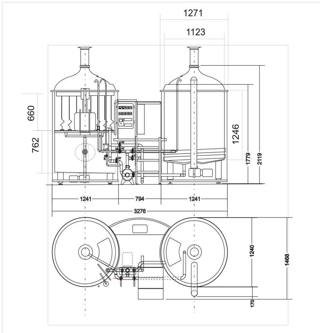
Варочный комплект V600 состоит из неподвижной конструкции материала 1.4301. В нижней части конструкции 8 регулировочных опор.
